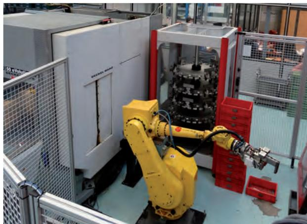
» Robot polyarticulé Erowa - dressage des ébauches
